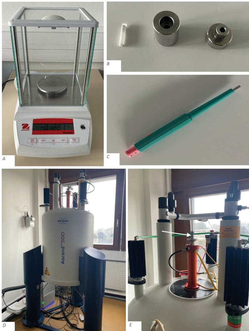
Figure 1 : Matériel utilisé pour l'analyse RMN-HRMAS. A : balance de laboratoire. B : Insert et clippeur métallique. C : Punch biopsie. D : spectromètre ASCEND 500 MHz Bruker©. E : Réceptacle de l'insert.
